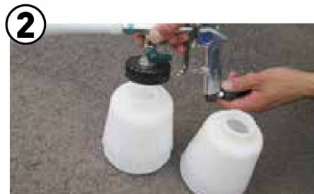
② トルネードガンにZAC消臭ミストのボトルを付け替えます。ボトルを取付後エアホースを取付けエアと液剤の試し噴射を行います。
