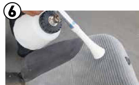
⑥ エア噴射に換えて再度同じ箇所を一定方向に水分を飛ばすように作業を行います。
