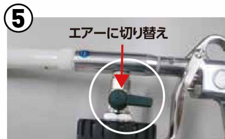
⑤ ④の作業が完了後エアを噴射に切り替えます。
