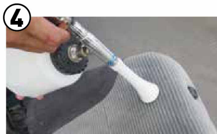
④ シート面とガンの距離を垂直1cmまでに近づけ噴射しながら一定方向に少しずつ移動します。(1シート目安100ml)
